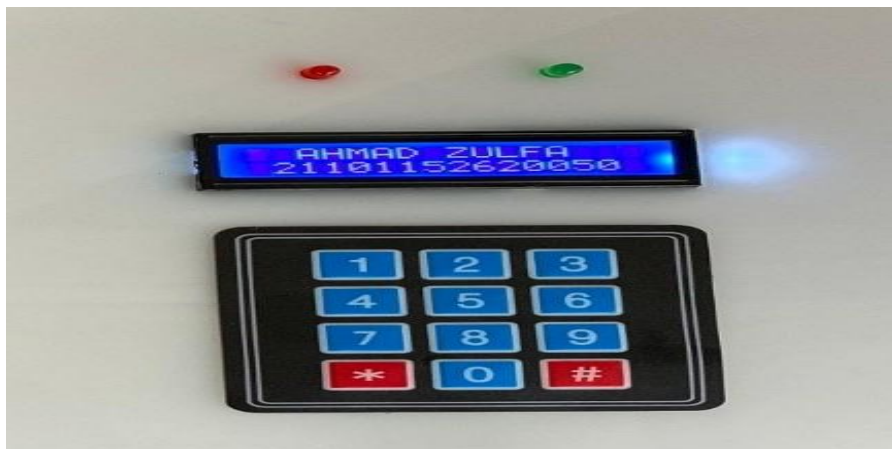
Gambar.2 Tampilan Awal LCD 16x2 Saat Alat Dihidupkan
