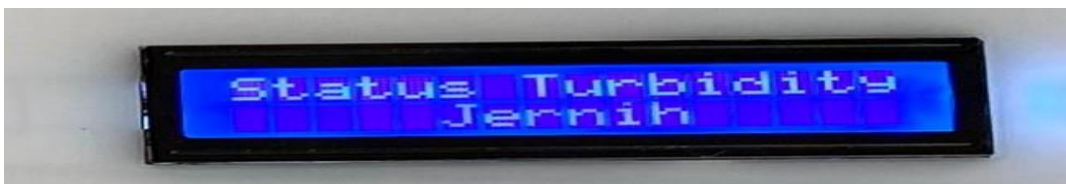
Gambar.7 LCD 16x2 Menampilkan Kekeruhan Air Berada di Tingkat Jernih
