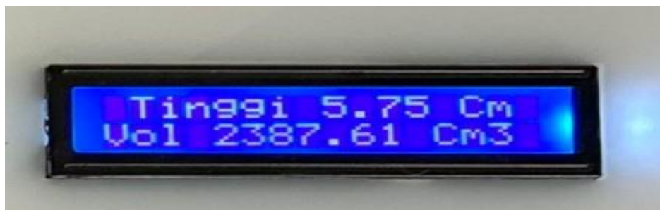
Gambar.3 Tampilan LCD 16x2 Menampilkan Volume Tandon Air
