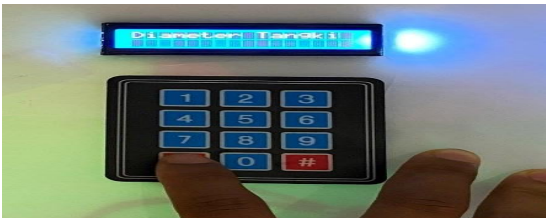
Gambar.11 LCD 16x2 Menampilkan Diamater Tangki Tandon yang Ingin Diubah
