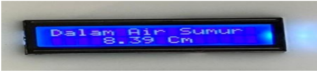
Gambar.4 Tampilan LCD 16x2 Menampilkan Kedalaman Air Sumur
