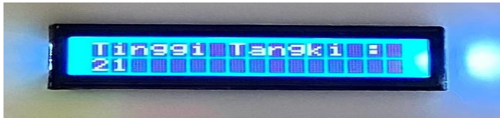
Gambar.12 LCD 16x2 Menampilkan Tinggi Tangki Tandon yang Ingin Diubah
