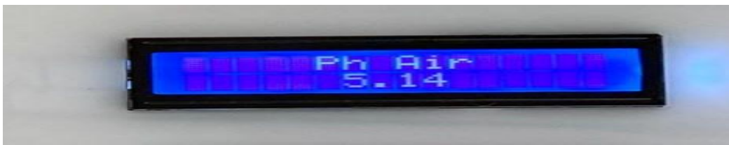
Gambar.5 Tampilan LCD 16x2 Menampilkan pH Air Sumur
