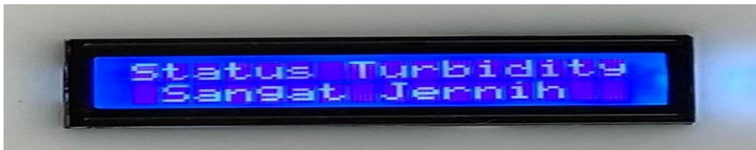
Gambar.6 LCD 16x2 Menampilkan Kekeruhan Air Berada di Tingkat Sangat Jernih
